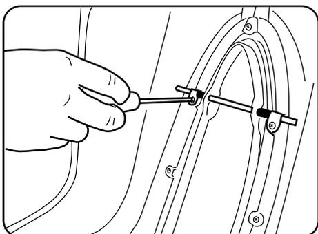
7. Utilizando un destornillador, apriete los tornillos en los agujeros originales.
