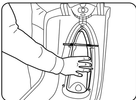
4. Desde el interior de la cubierta, alinee la tapa y la apertura de modo que el eje se sitúe en su emplazamiento.
