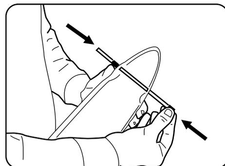
3. Coloque un espaciador a cada lado del eje.
