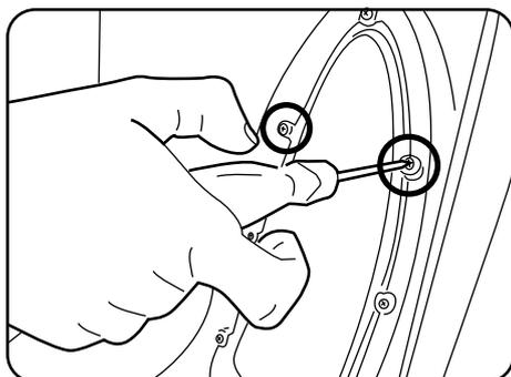
1. Desde el interior de la cubierta, retire dos tornillos del embellecedor de la apertura.
